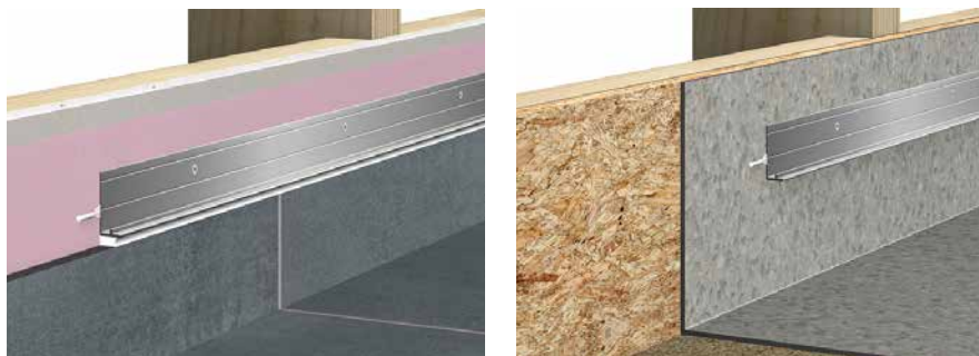
Fibo Baderomspanel trukket 6-8 cm opp fra gulvet, og erstattet med golvbelegg eller sokkelflis
