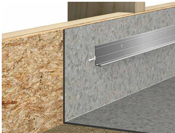
Fibo Baderomspanel trukket 6-8 cm opp fra gulvet, og erstattet med golvbelegg eller sokkelflis
