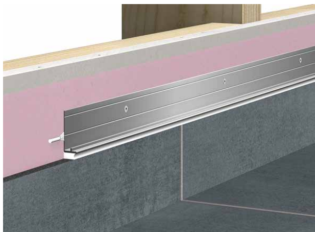
Fibo Väggskiva monterad 6–8 cm upp från färdigt golv och ersatt med golvmatta eller klinkersockel
