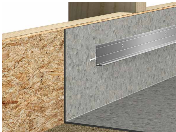
Fibo Väggskiva monterad 6–8 cm upp från färdigt golv och ersatt med golvmatta eller klinkersockel
