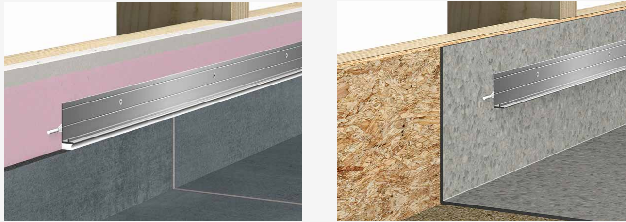
Fibo-seinäpaneeli 6–8 cm valmiin lattian yläpuolelle asennettuna. Seinäpaneelin alareunan ja lattian väliin jäävä tila voidaan peittää nostamalla lattiamateriaali seinälle tai käyttämällä helmalaatoitusta.
