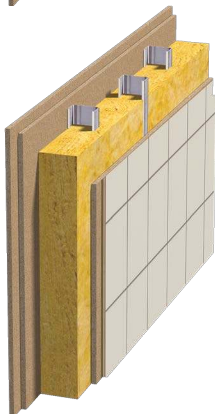
Gjennomgående stålstender med ett platelag
