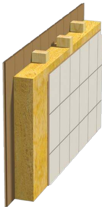
Fig. 2 Innvendig vegg Forskjøvet heltre stender på heltre svill. To platelag.
