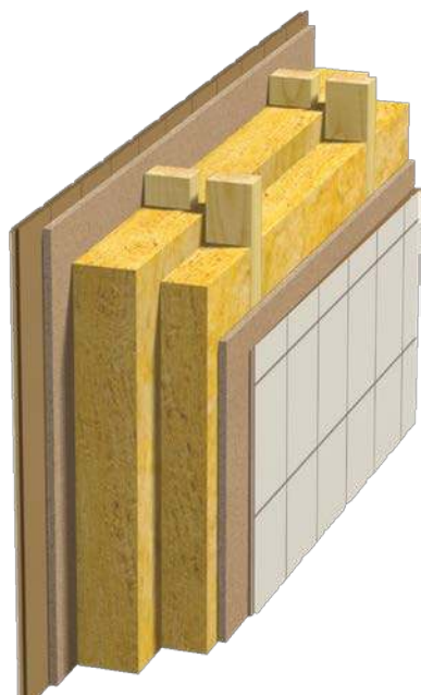
Fig. 4 Innvendig vegg. Dobbel heltre stender. To platerlag.
